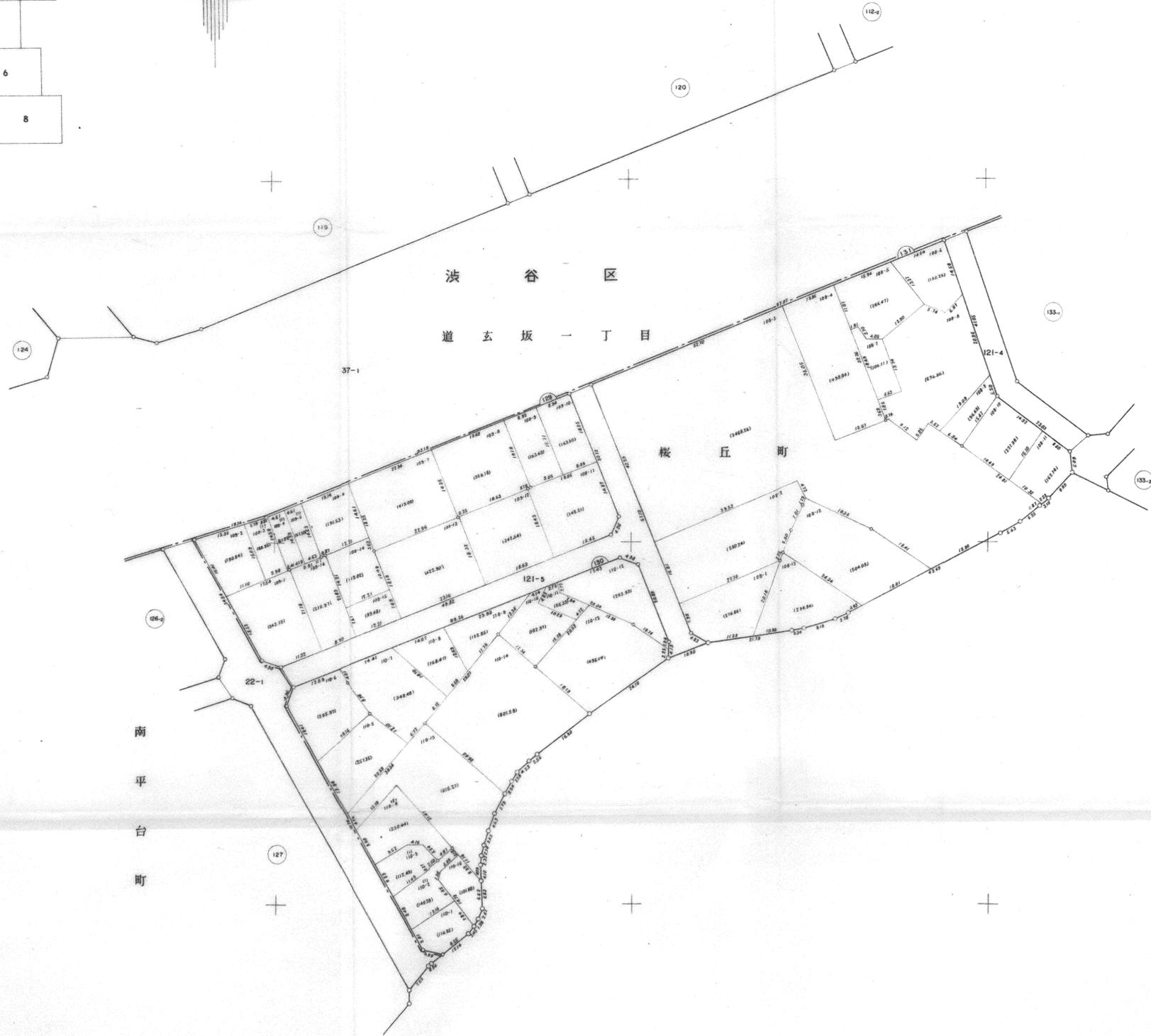
本図の辺長地積は、間坪による確定測量成果を計量法の施行に伴いそれぞれ換算したものである。
